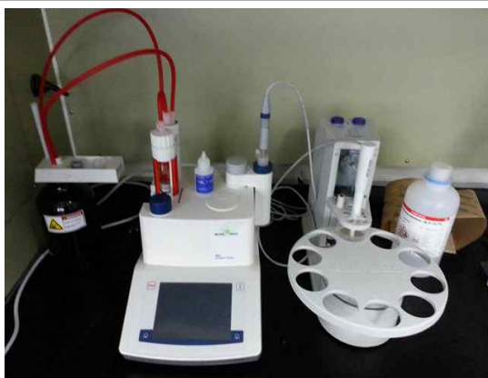
위 치 시험전경 내 용 염화물 함유량시험
